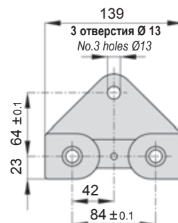
Вид установочного основания View on caliper base
